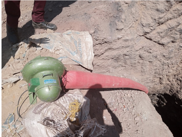
Figure 74. Exemple de turbine utilisée dans une mine artisanale.
