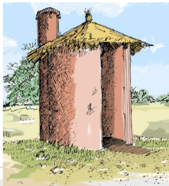
Figure 44. Image de toilettes VIP fabriqué en terre crue et paille. © WEDC and Solidarités international
