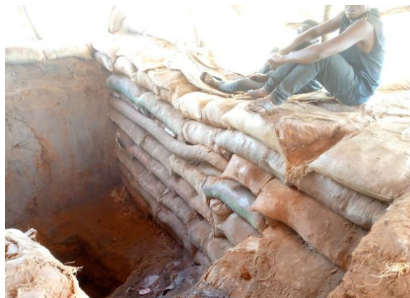
Figure 67. sacs de stériles qui évitent les problème de glissement de remblais ou de pierres et protègent des ruissellements, dans une mine de cobalt.
