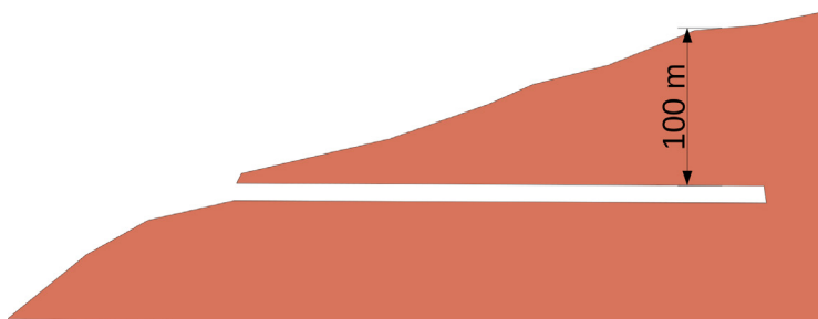
Figure 54. vue en coupe de la hauteur de roche au-dessus d'une galerie souterraine. La pression dépend de la hauteur de roche au-dessus.
