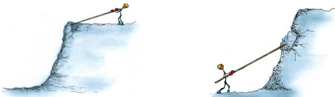
Figure 42 . schéma purge des gradins, par au dessus et par en dessous. D'après Walle & Jennings, 2001.
