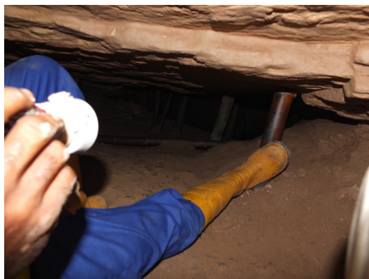
Figure 63. Exemple de renfort horizontal dans une mine artisanale et filonienne d'or.
