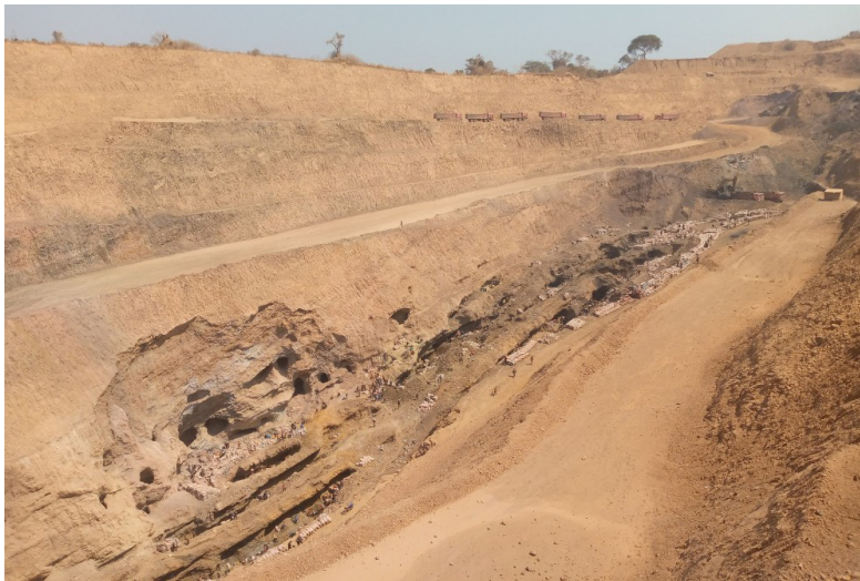
Figure 28. exemple de fosse d'extraction à ciel ouvert avec des engins lourds et des artisans miniers, et des ouvrages souterrains en base de fosse.
