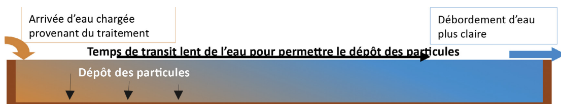
Figure 32. principe du bassin de décantation des eaux de traitement. Le bassin est vu ici en coupe.
