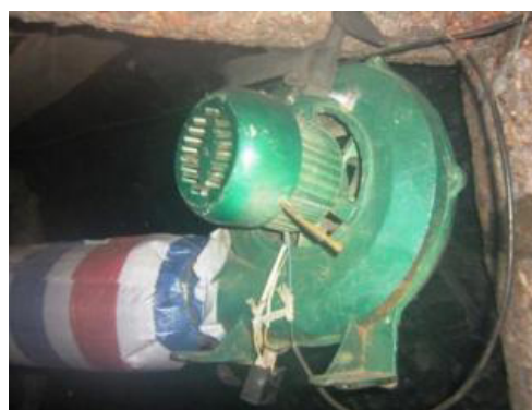
Figure 72. Exemple de turbine d'aérage dans une mine artisanale. On remarque la largeur du tube de transport de l'air.
