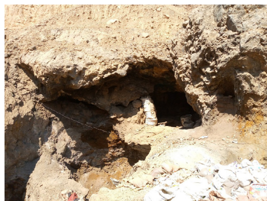
Figure 36. Exemple de surplomb dans une mine de cobalt.
