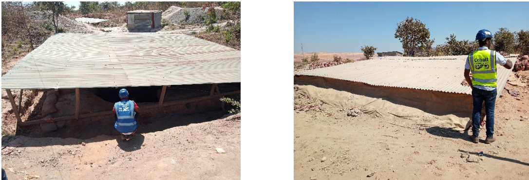
Figure 70. toiture en tôle autour d'un puits dans une EMAPE de cobalt.
