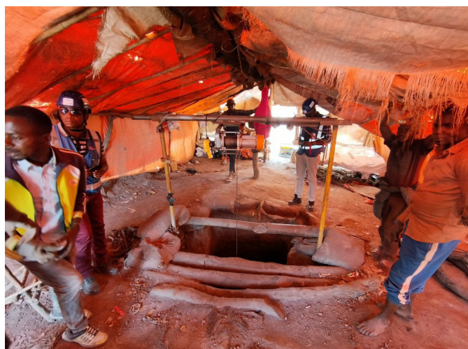
Figure 51. exemple de puits de descente équipé d'un treuil électrique pour faciliter la descente du matériel et du personnel ainsi que la remontée du minerai.
