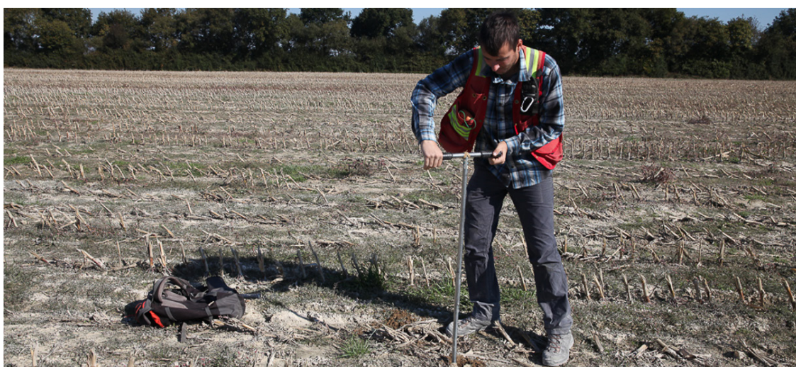
Figure 26. Manipulation d'une tarière manuelle pour sols. © Gexplore.fr.
