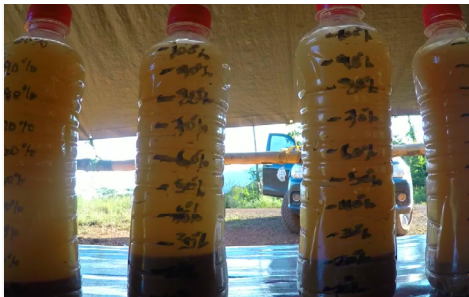
Figure 38. Méthode en 3 étapes pour la mesure du pourcentage de matières solides dans l'eau, © GGMC.
