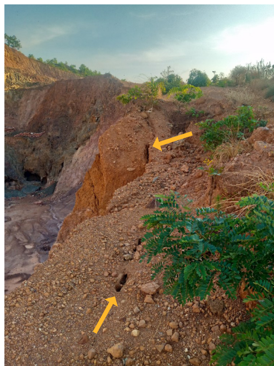
Figure 22 : exemple de signaux de zones d'effondrement de parois mal gérées.
